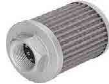
GE 2588 T Kubato RB23862150 OD 82.5 T 1 1/4 NPT ID2 Kapalı H 108
